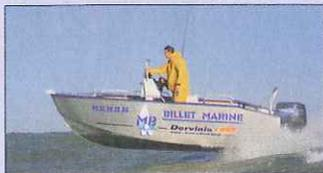
Dessiné par l'architecte naval Pierre Delion le nouveau Dervinis 495 dispose d'une coque en aluminium, moussée. Sa carène est performante et la console de pilotage intègre une table pliante, derrière le leaning post.
