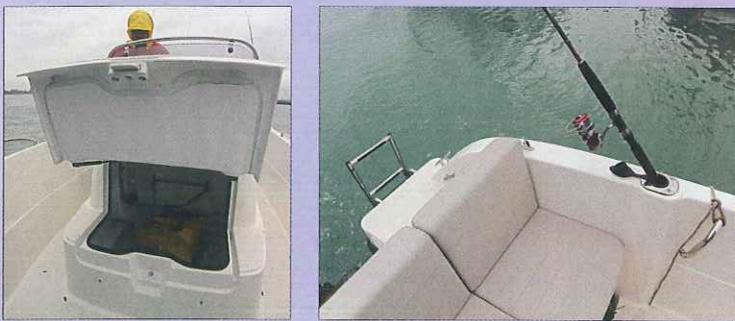
Placé devant la console de pilotage, le siège se soulève grâce à un vérin pneumatique et dévoile l'accès à une petite cabine qui fait office de vaste rangement.
